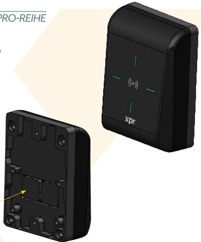
Die Öffnung hat in der Mitte zwei herausbrechbare Quadrate. Je nach Verkabelungsanforderungen können eines oder beide Quadrate herausgebrochen werden. Es besteht außerdem die Option der Verkabelung von allen vier Seiten
