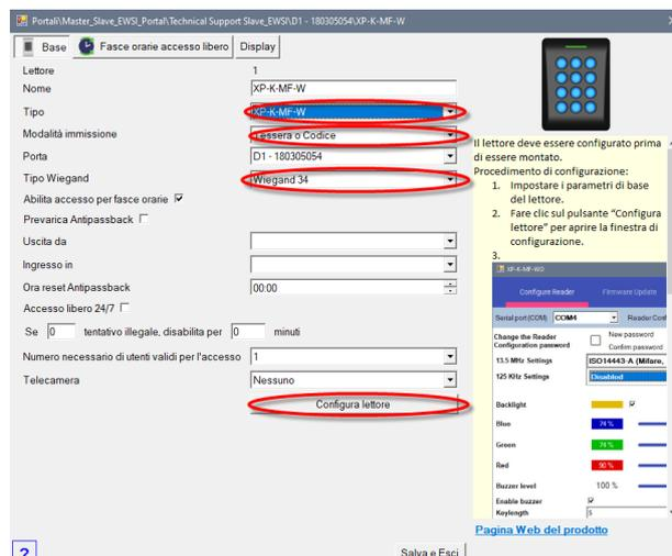
1.3 Collegare il lettore al PC utilizzando un cavo micro-USB. Se il lettore viene riconosciuto dal PC, nel campo "Porta Seriale (COM)" verrà visualizzata la porta di comunicazione a cui è collegato il lettore, ad esempio "COM4". Se non è presente alcun valore nel campo "Porta seriale (COM)", cambiare il cavo USB.
