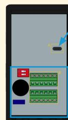
**Micro USB :** Connexion à l'ordinateur pour la configuration et/ou la mise à jour du micrologiciel
