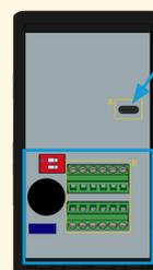
**Micro USB:** Para conectar al ordenador para la configuración y/o actualización del firmware.
